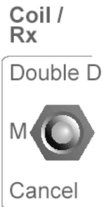
Переключатель для изменения типа поисковой катушки. Он позволяет детектору работать с DoubleD и Mono катушками. Использование различных катушек дает возможность точно отстраиваться от минерализации грунта, тем самым увеличивая глубину обнаружения. Coil / Rx – можете использовать как с катушками DoubleD так и Mono. Например, установив катушку типа DoubleD переключив переключатель Coil / Rx в положение M вы увеличите глубину для небольших самородков.
