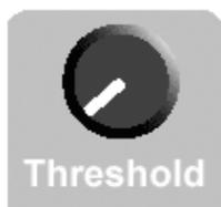
Постоянно слышимый звук в наушниках. Изменение характеристик порогового тона свидетельствует о наличии металлического объекта под катушкой прибора. Уровень громкости необходимо выставлять так, чтобы пользователь чувствовал себя комфортно. Если уровень громкости порогового тона установлен слишком низко или слишком высоко, маленькие целевые сигналы не будут различимы. (см.рис.).
