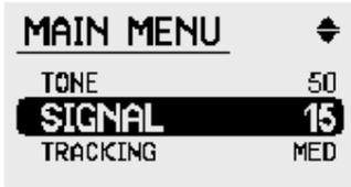
Настройка помогает отличать большие глубинные цели от небольших поверхностных по тону сигнала. Целевой сигнал на GPX 4500 двух тональный, но если вы захотите Вы можете установить моно сигнал. Целевой сигнал, который сначала уменьшается и затем повышается, - обычно указывает на глубоко лежащую цель. Повышение и затем падение тона указывает на маленькую цель.
