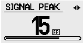
Настройка **Signal Peak** устанавливает уровень разницы между высокой и низкой тональностью сигнала.
