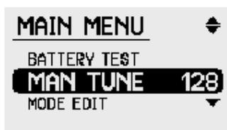
От электрических помех вы можете отстроить детектор как в автоматическом режиме так и в ручном. Кнопка автоматической отстройки Auto Tune находится на задней панели управления. Если по каким то причинам автоматическая отстройка вам не понравилась или не хочется тратить время на ожидание вы можете вручную подстроить детектор на менее шумный канал.
