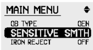
Переключатель на задней панели управления Soil/Timings (установка детектора на различные типы почв и размер цели) в режиме Sensitive (чувствительная к мелким целям) имеет два дополнительных параметра доступные через меню Smooth и Extra.
